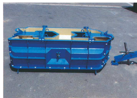
(3)型枠組立完了
