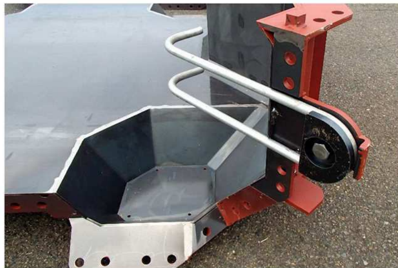
シークロスR型 連結金具固定完了
